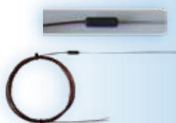
**Applicazione:** Misure di temperatura max Tc J 400 °C / Tc K 600 °C
